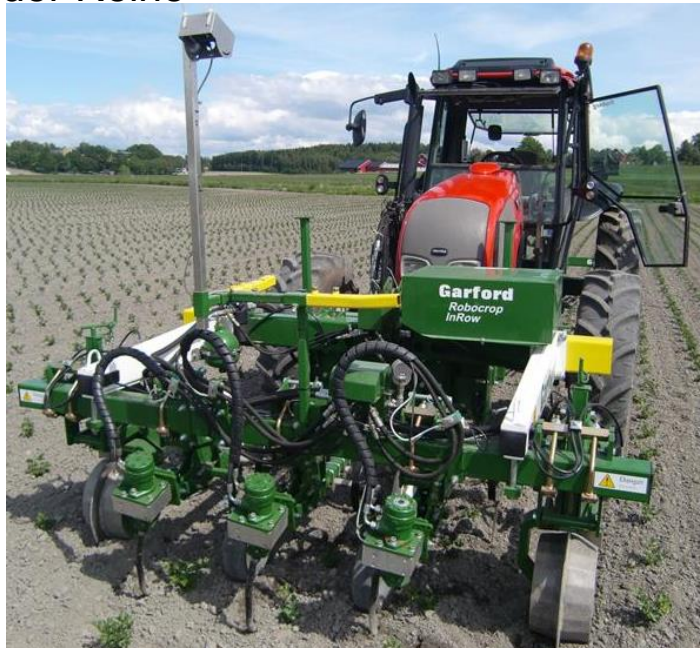
Garford Robocrop hacken zwischen Reihen und in der Reihe
