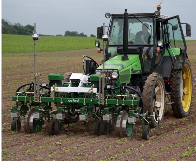
Garford Robocrop hacken zwischen Reihen und in der Reihe
